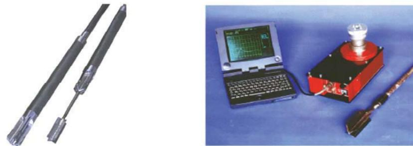
El molinete es de tipo rectangular con diámetro 65 mm y altura 130 mm y las varillas de extensión son de acero con diámetro 22 mm.
