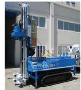
Las perforaciones se han realizado con diámetros comprendidos entre 101 y 86 mm, utilizando coronas de diamante o *widea* en función de la tipología de material atravesado.
