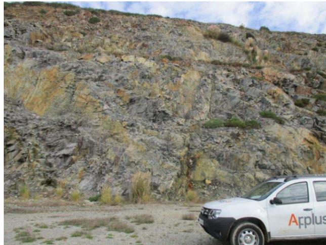
**Figura 8.** Ortogneis del talud exterior del puerto exterior de A Coruña.
