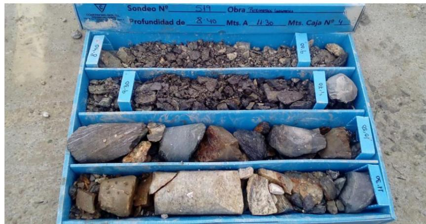
Figura 49. Tramo de escollera entre 9,90 y 11,30 metros en sondeo SP-19
