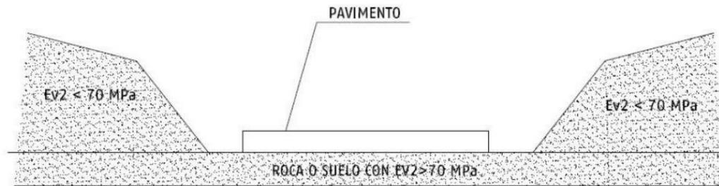
Figura 58. Sección tipo esquemática de fondo de desmonte y material de sustitución para vía sin balasto (Norma 7-1-0.7 Diseño y montaje de vía sin balasto)
